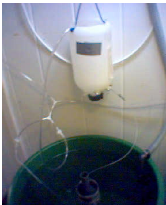
Figur 7: Drypptank med justerbar høyde, polyetylen slange ned i karet, luftslange med lodd for omrøring i drypptanken.
