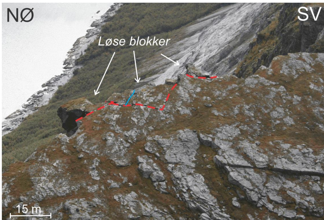
Figur 40. Helikopterfoto med tolkning av sprekker og baksprekker på kanten av Brosmebakktaua. Tegnforklaring i figur 13. Foto: I Henderson, 2006 (NGU), modifisert til oppgaven.
