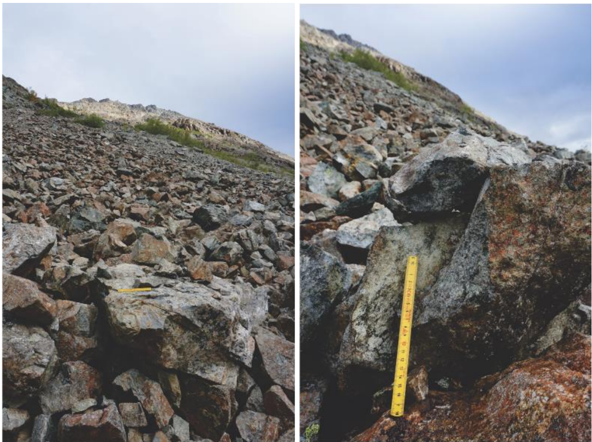
Figur 35: Bildene viser to eksempler på balanserte steiner i bunn av den vestlige skredviften i B1a. Bildene er tatt i punkt 5 på Figur 36.
