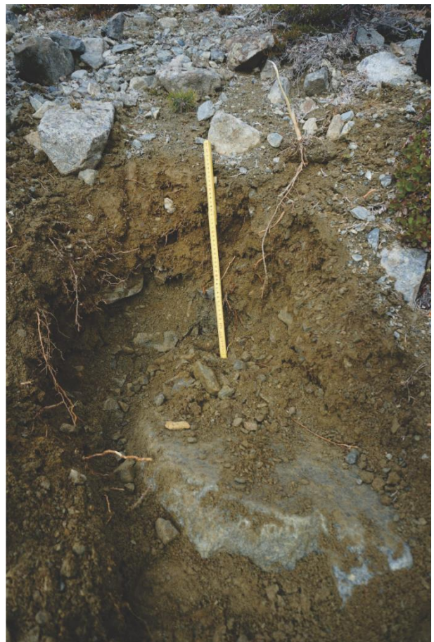
Figur 31: Den tverrgående ryggen i B1b består av alle en rekke kornstørrelser fra silt til blokk. Bildet er tatt i punkt 1 i Figur 36.
