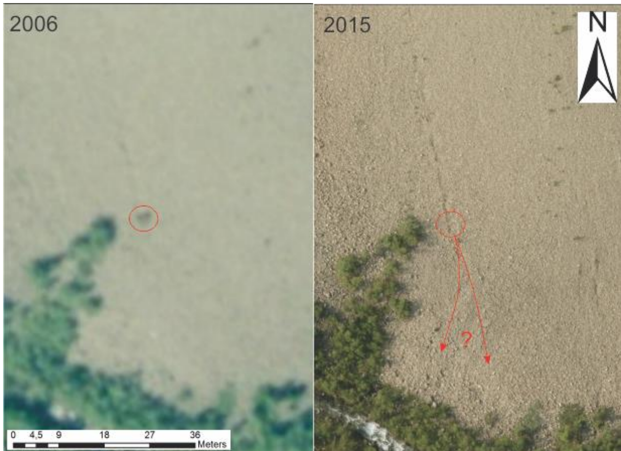
Figur 98: Sammenligning av spor etter steinsprang. I 2006 ser det ut til at det ligger en blokk i bunn av sporet, mens i 2015 er blokken flyttet.
