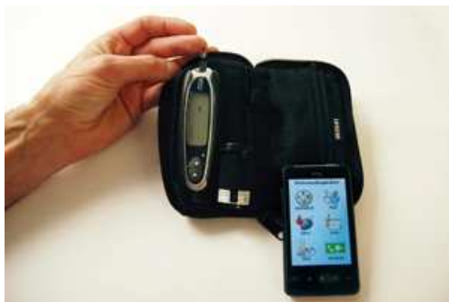
Рисунок 15 Дневник больного диабетом на смартфоне с передачей измерений уровня глюкозы в крови через Bluetooth позволяет легче управлять таким хроническим заболеванием, как диабет (Фото: Jarl Stian Olsen)
