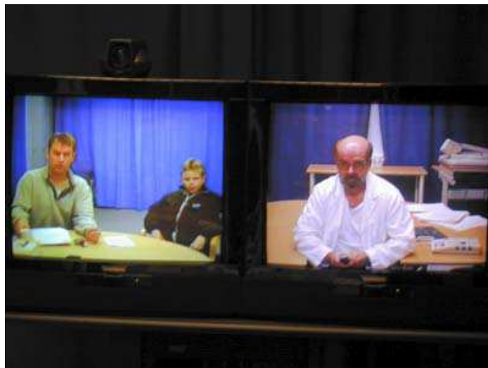
Рисунок 269. В начале, разделить экран было невозможно. Поэтому использовались два монитора, один для входящего изображения, другой для трансляции исходящего изображения. (Фото: NST)
