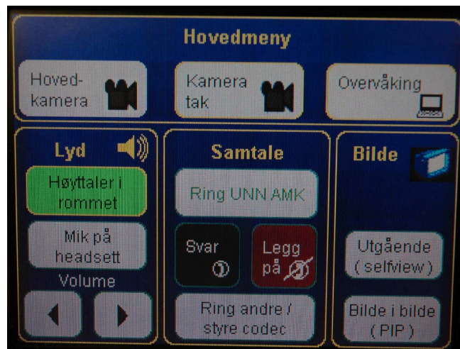
Рисунок 9 Основное изображение панели управления в больнице Лонгиербюена. Идея заключалась в том, что для связи с UNN достаточно нажать одну кнопку. (Фото: Оддвар Хаген)
