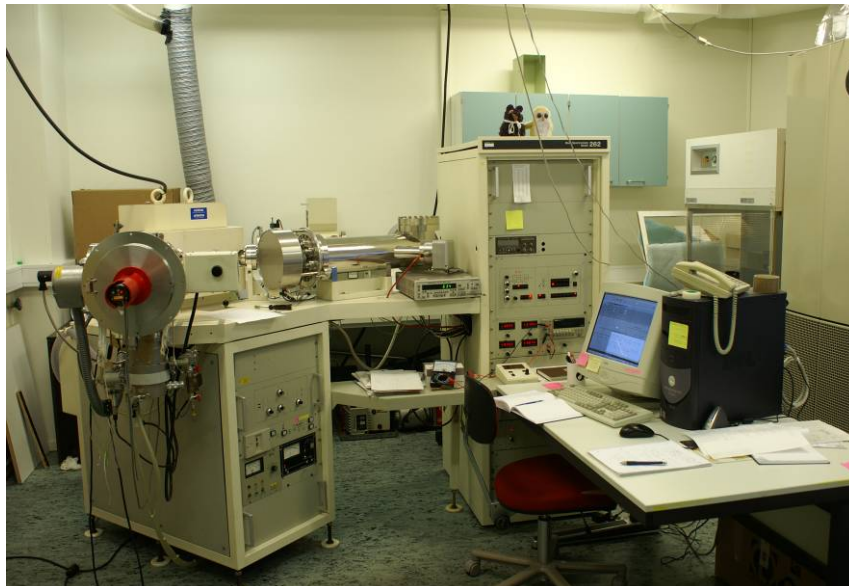
Figur 6.3 Finnigan MAT 262 faststoff-massespektrometer ved IG, Universitetet i Oslo.
