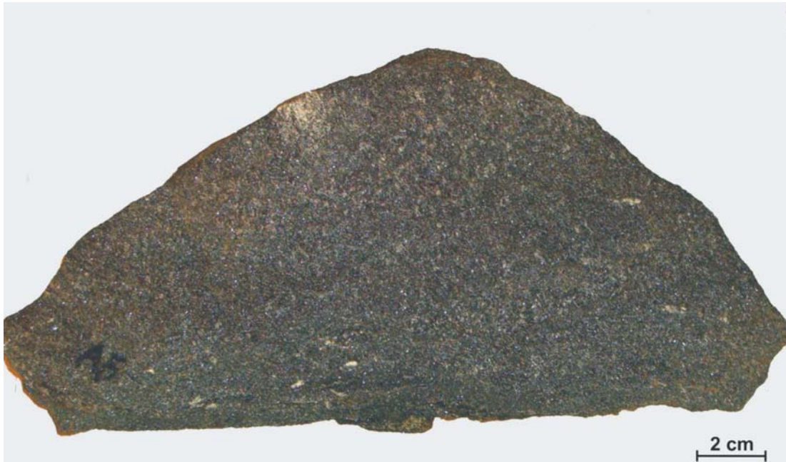
Figur 3.4 Prøve A5 ble tatt lengre ut mot marginene av linsa (Figur 3.1) og er en foliert og tilnærmet svart/grå bergart med små granater, og klassifiseres som en amfibolitt.
