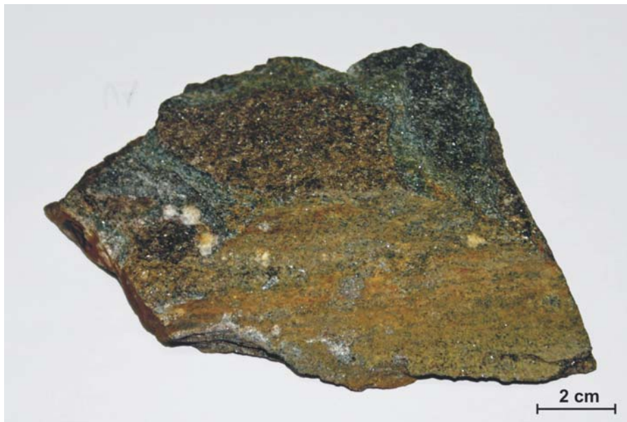
Figur 3.5 Prøve A7, som ble tatt ganske langt ut mot marginen av linsa (Figur 3.1): er sterkt foliert uten synlige rødlig granater og klassifiseres også som en amfibolitt.
