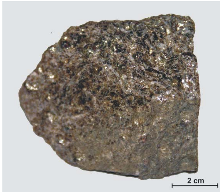
Figur 3.25 Prøve B1 fra østsiden av veien: Denne prøven har blitt sterkt foliert, og man ser store flak av glimmerminerale.
