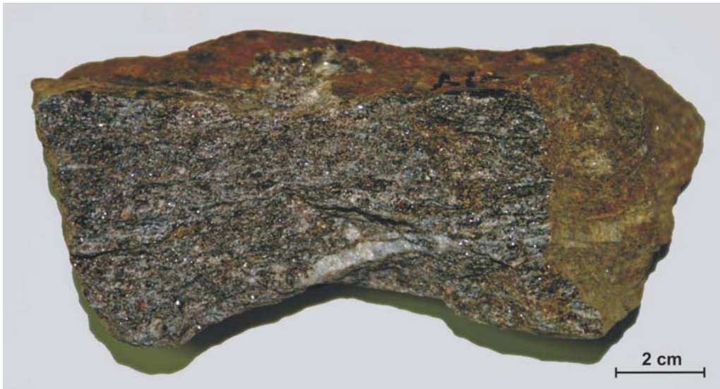
Figur 3.24 Prøve A12 fra vestsiden av veien: Mineralene ligger orientert i prøven. Denne prøven er litt mindre grovkornet enn de på østsiden av veien.
