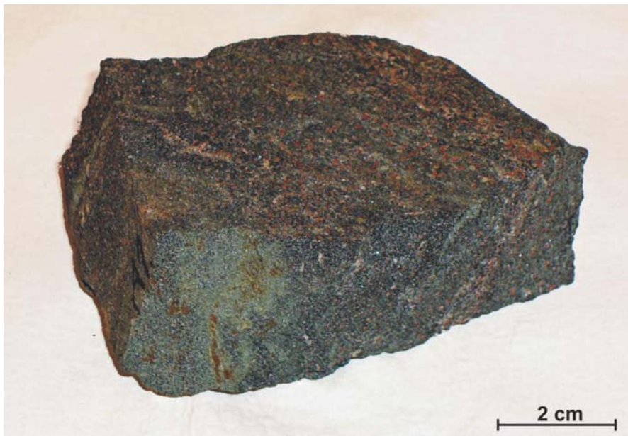
Figur 3.3 Prøve A1 fra den sentrale del av linsa er svakt foliert med vekslende grønnlige klinopyroksen-rike og gråsvarte amfibol-rike bånd med jevnstore rødlig granater.
