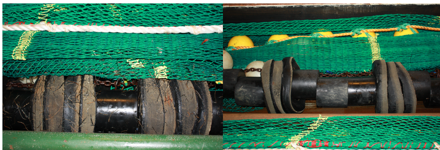
Figur 18. 14" RHG brukt under toktet i februar/mars 2017. Bildet til venstre viser midtseksjonen og bildet til høyre viser sideseksjonen av gearet. Foto av undertegnende.
