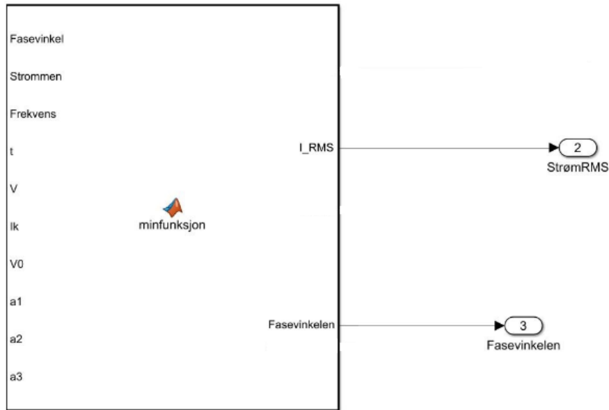
Figur 6-1 Modell ramme for generell-og impedans lastmodell, utgang rms-verdi og fasevinkelen.
