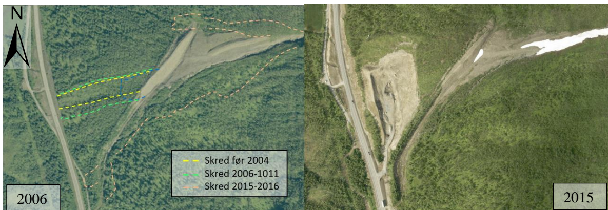
Figur 16: Sammenligning av flyfoto fra 2004-2016 viser tydelig tegn på skredaktivitet. Stiplede linjer viser skade på vegetasjon i de ulike periodene. Bildene i figuren er fra 2006 (t.v.) og 2015 (t.h). Bildet fra 2015 viser også skredmagasinet som ble bygget i 2012. Hentet fra Kartverket (2018b).
