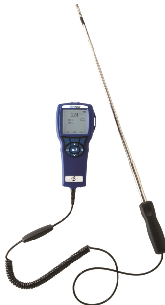
Figur 3.4: TSI 9565 med tilhørende probe for hastighets-, relativ luftfuktighets- og temperaturmålinger.
