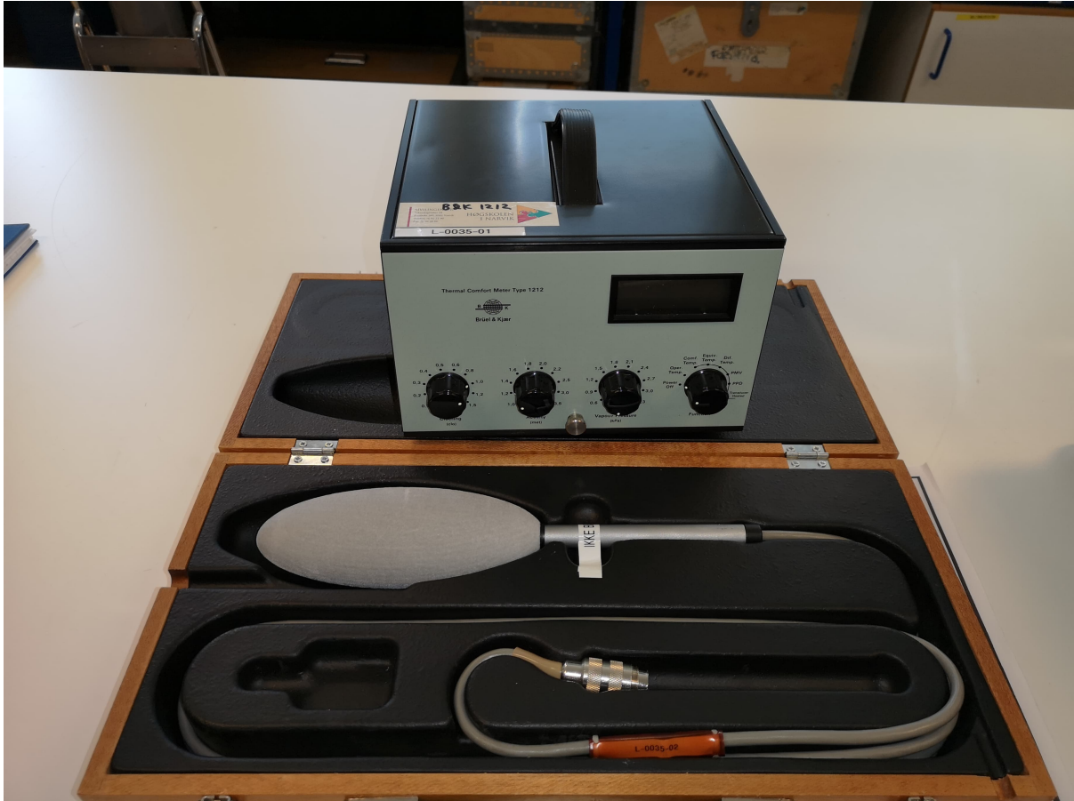
Figur 3.6: B&K 1212 fra forsiden, med regulatorer for aktivitetsnivå, bekledding, vannets partialtrykk og en regulator for hvilket parameter som skal måles. Foran måleinstrumentet ligger den tilhørende proben
