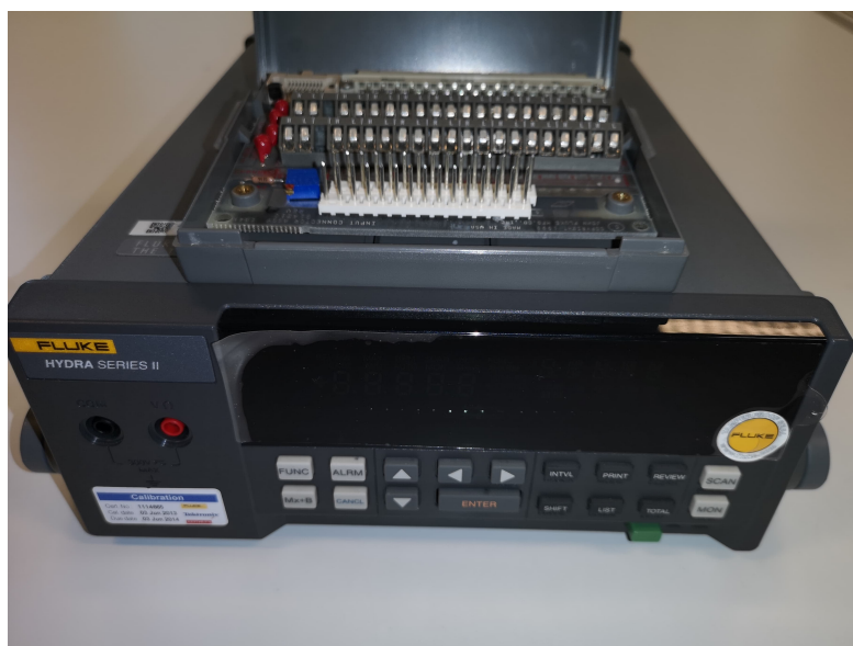
Figur 3.5: Fluke 2625A Hydra series II data logger med tilhørende krets for termotråder.
