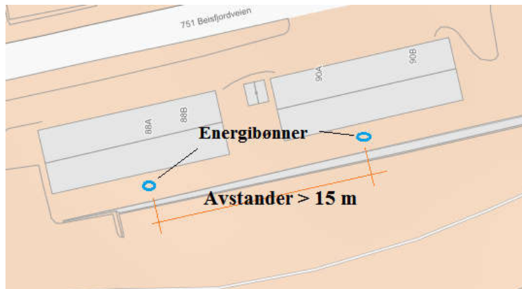
Figur 4.6 Energi bønner for bergvarme
