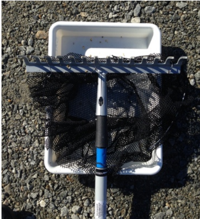
Figur 2. "Blåskjellskrape" konstruert av en stålrake og et nett bundet til slik at man kan rake blåskjell fra en avstand på ca. 2 meter
