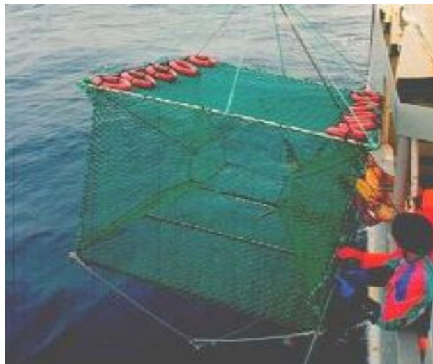
Figur 23: Firkantteine (sammenleggbare) brukt ved fangst av kongekrabbe. Norske teiner måler 1 x 1,2 x 1,2 m. Flyteelementene lokalisert på toppen holder teinene åpne i sjøen (Havforskningsinstituttet, 2013).
