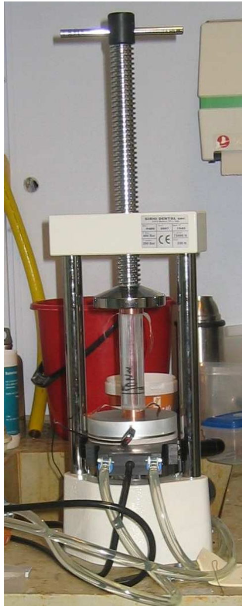
Figur 5.8: En transduser limes fast mellom en PMMA-sylinder og en kobberplate i limpressa. Limpressa holder en temperatur på 60 °C.
