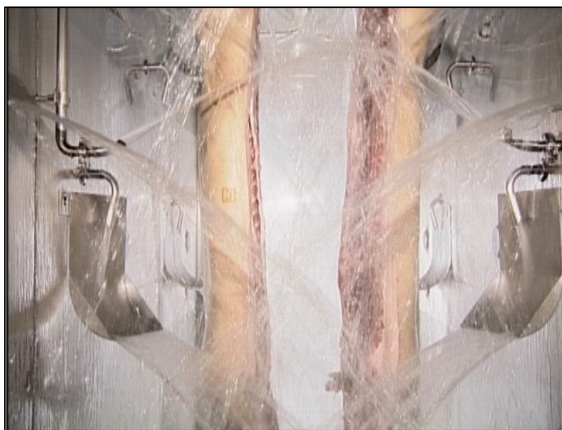
Figur 1. Overflatepasteurisering i lukket kammer (Hardy Christensen)
