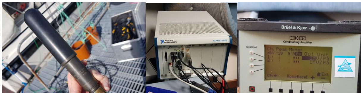
Figur 11. F.v: en Brüel & Kjær-hydrofon, en PXI fra National ble brukt for å loggføre data, en Nexus conditioning amplifiser med fire kanaler. Foto: Tonje Nesse Forland ved HI
