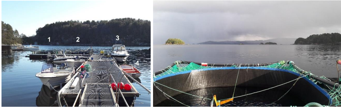
Figur 7. Oppsett til eksperimentet for å teste effekter av seismikk på torsk under gyteperioden. T.v. Eksponeringsområde: (1) merd 1; (2) merd 2; (3) båten hvor teknisk utstyr som ble brukt til å loggføre data fra ekkolodd, hydrofoner, sensor for partikkelbevegelse; (4) robåten som ble brukt til å ro 140 m mot den andre siden av sundet og tilbake med mini-luftkanonen. T.h. Kontrollmerd 2, merd 1 ligger ved siden av. Teknisk utstyr tilsvarende det i eksponeringsområdet og ble oppbevart i en bu omtrent 5m fra merdene. Foto: Anette Walle
