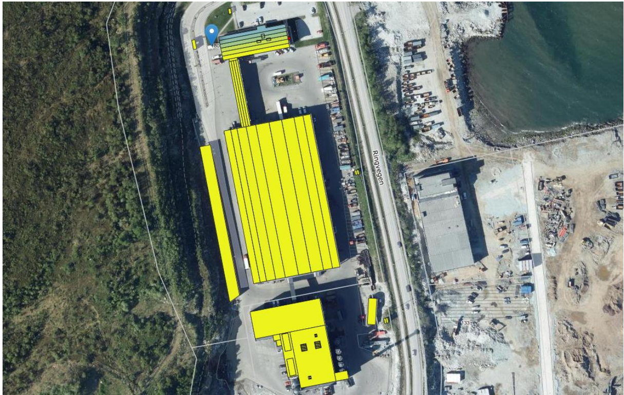
Figur 3 Et kart som viser solpotensialet for administrasjonsbygget helt nord på bildet og produksjonsbygget lengre sør. Det siste bygget er Kvitebjørn AS sitt anlegg som ikke utgjør en del av denne vurderingen. Hentet fra solkart.no [24]
