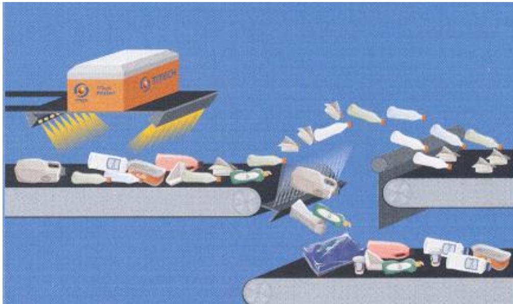
Figur 1 NIR-maskin, sorter fraksjoner ved å identifisere bølgelengden til forskjellig type avfall. Med tillatelse fra Rudolf Meissner overingeniør ved IVAR
