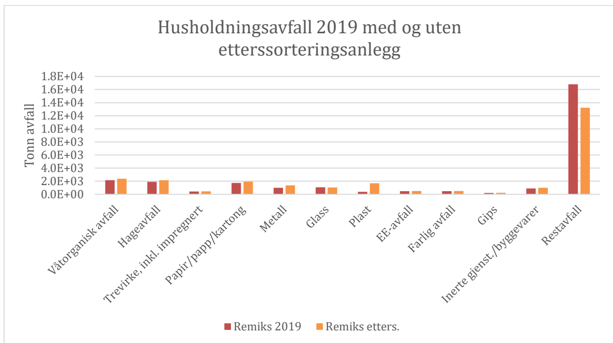
Figur 12 Statistikk på vær fraksjon før og etter tenkt implementering av et ettersorteringsanlegg, figuren viser tonn avfall på vær fraksjon.
