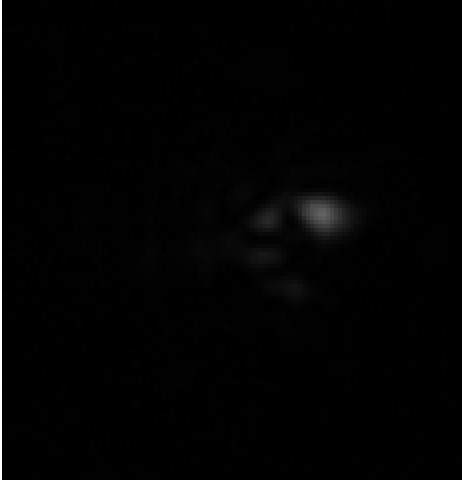
Figur 5.23: Kule med d=103\mu m i resonans, vi ser sideflekker i tillegg til senterflekken.
