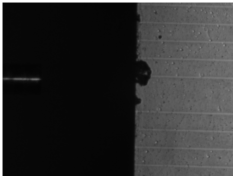
Figur 4.2: En skadet kanal
