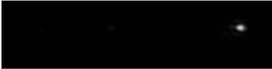
Figur 5.4: To mikrokuler, den høyre i resonans ved \lambda \approx 968.2\text{nm}
