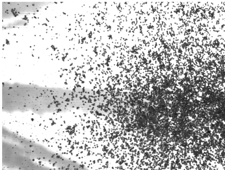
Figur 5.1: En ansamling av mikrokuler med d \approx 15 \mu\text{m}
