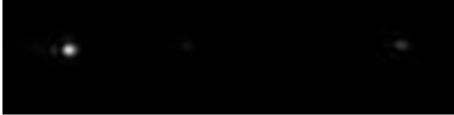
Figur 5.5: To mikrokuler, den venstre i resonans ved \lambda \approx 970.6\text{nm}
