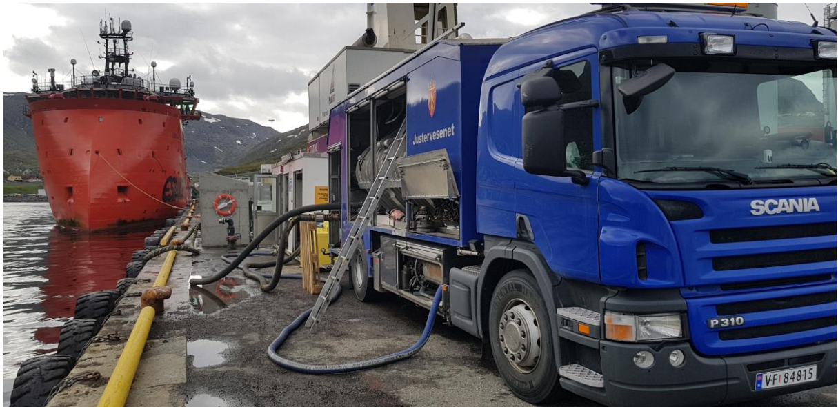
Figur 3. Justervesenet har to slike tankbiler som brukes i forbindelse med tilsyn med store gjennomstrømningsmålere på tankanlegg o.l. (Foto: Justervesenet).
