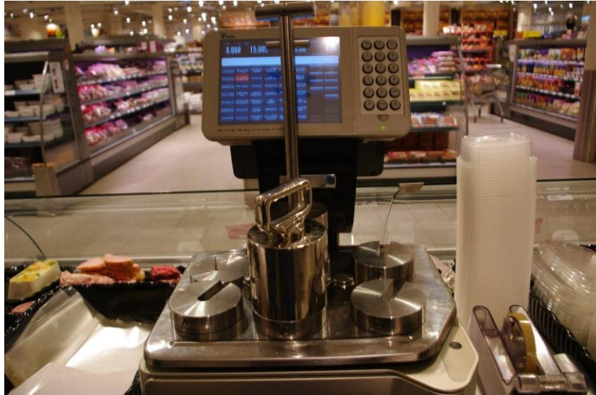
Figur 1. Tilsyn med vekt i dagligvarebutikk. Svært nøyaktig loddmasse veies for å kontrollere vekten (Foto: Justervesenet).
