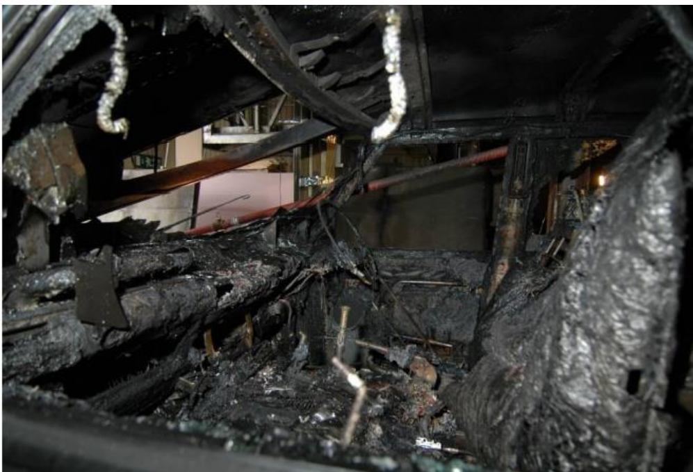
Figur 20 - Bildet viser skadene i den nederste bilen etter endt forsøk (79).
