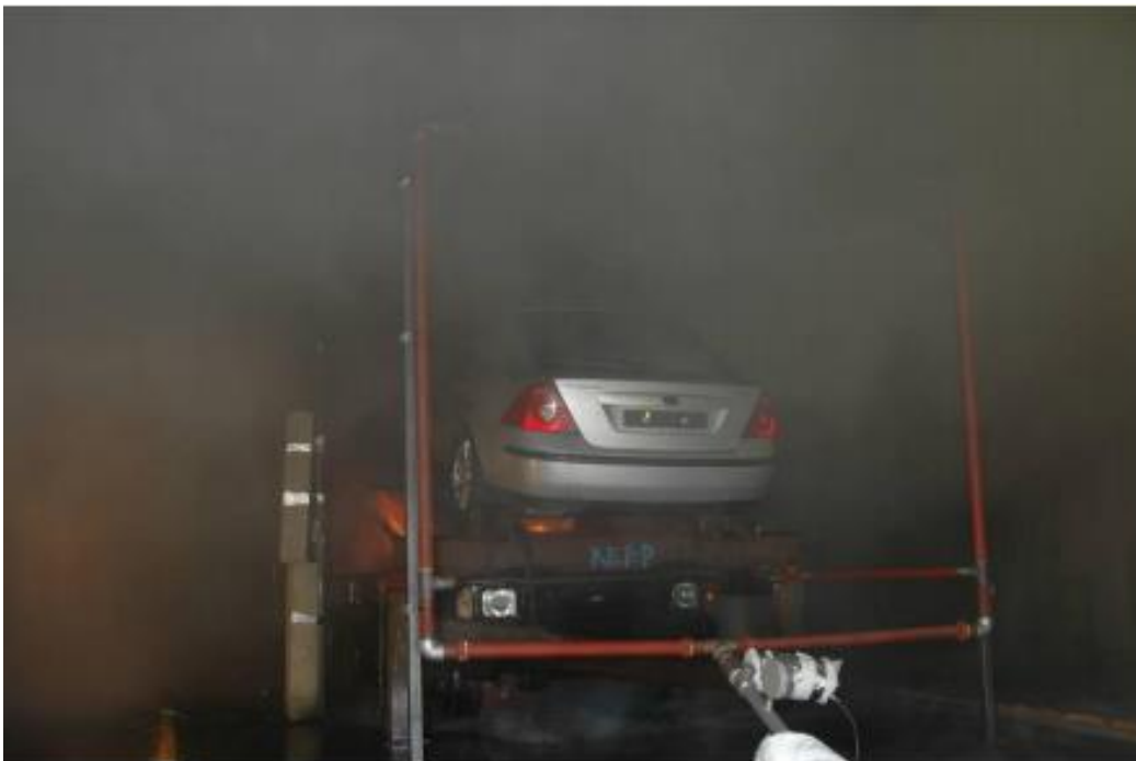
Figur 19 – BAFSA (BRE Global) testen etter 20 min og 53 sekunder (med sprinkler) (79).
