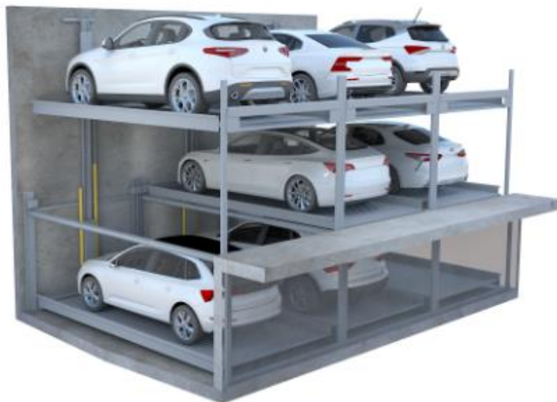
Figur 5 - Prinsippkisse av en combilift med 3 plan (53).
