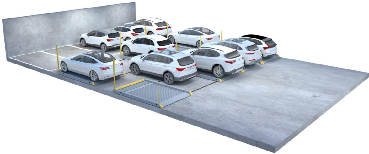
Figur 6 - Viser en prinsippskisse av et flåteparkeringsanlegg med to rader med forskyvbare flåter (54).
