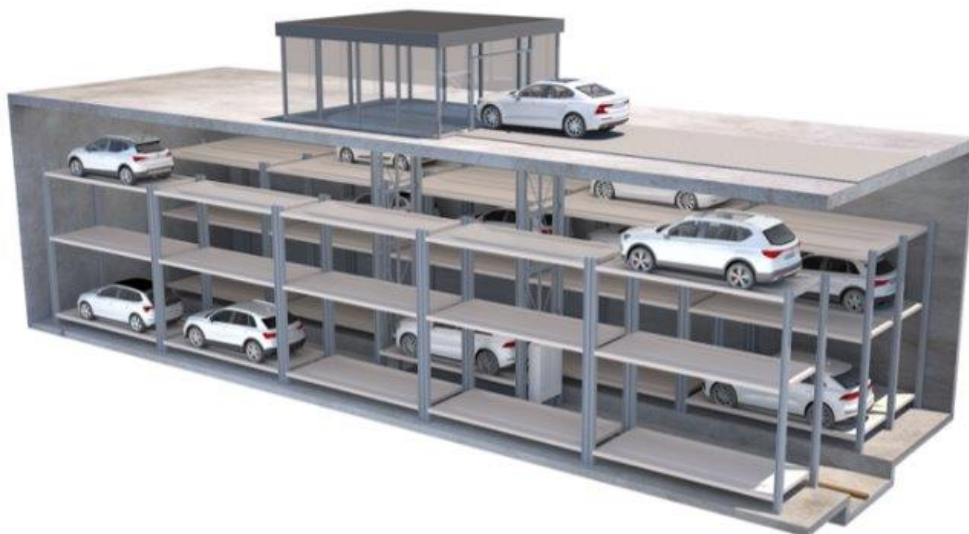
Figur 4 – Prinsippkisse av et typisk helautomatisk parkeringssystem med tre plan (50).
