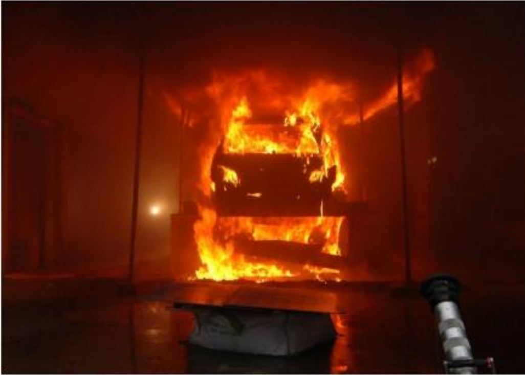
Figur 18 – CLG-testen etter 20 min og 59 sekunder (uten sprinkler) (79).
