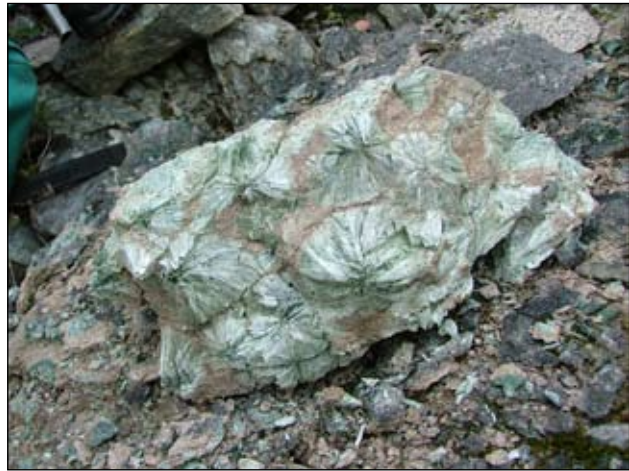
Fig. 2. Asbest fra Virdejavre. Fotografert in situ. Merk fibrene som stråler ut fra sentrum og den lyse grønne fargen. Foto: Ø. Sundquist
