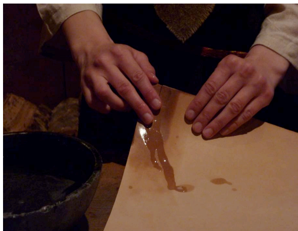
Figur 6 Læret blir fuktet med vann.
