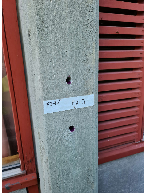
Figur 1. Innhenting av støvprøver for analysering i laboratorium. Foto. Eirik Erdal
