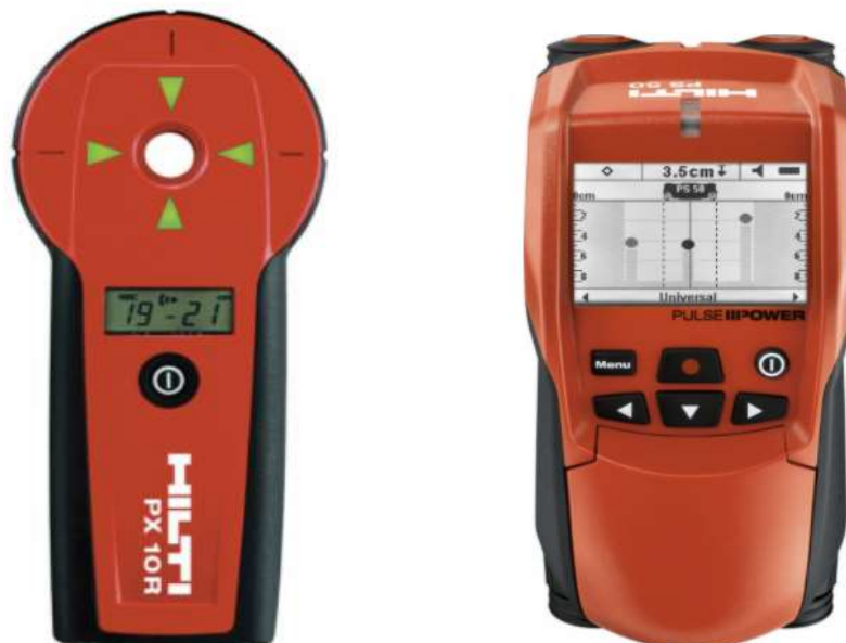
Figur 2. Viser to måleverktøy hvor den ene bare oppgir avstand mens den andre oppgir avstand og bilde av jernene som finnes inne i betongen. (Foto fra hilti.com)
