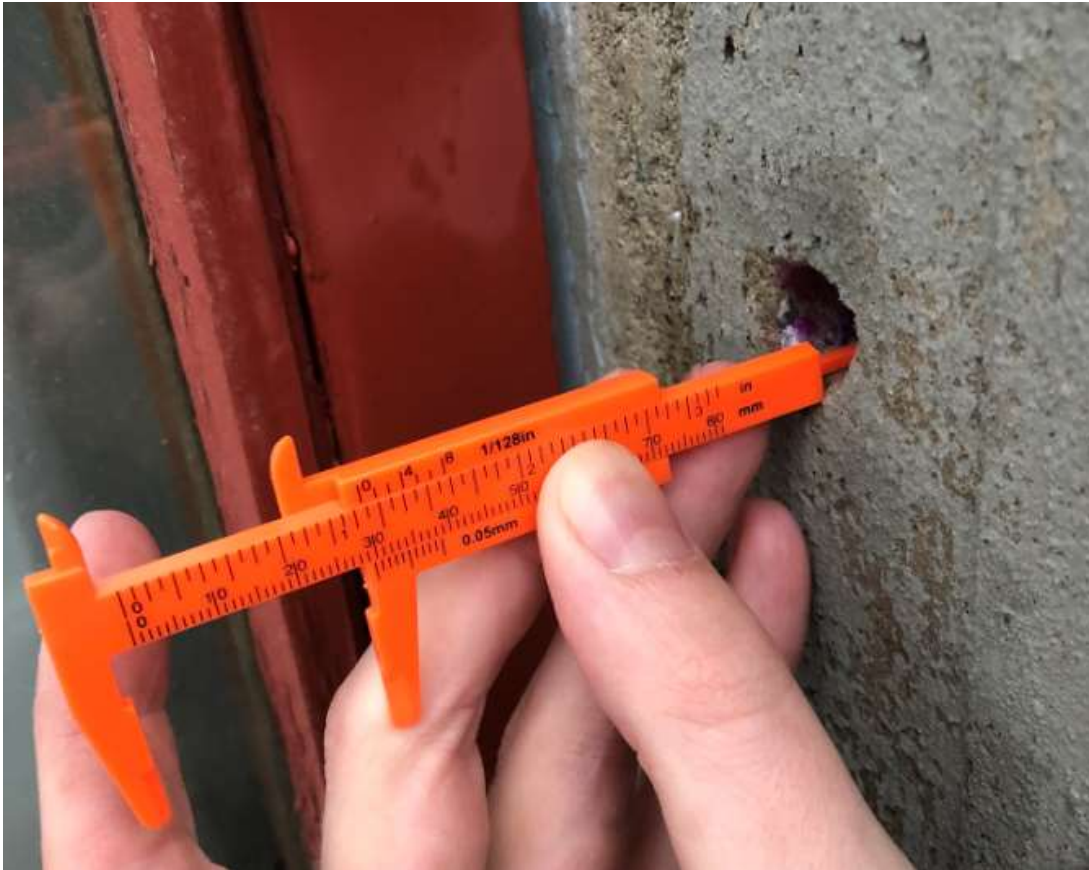
Figur 30. Målt karboniseringsdybde plan 3 østfasade.
