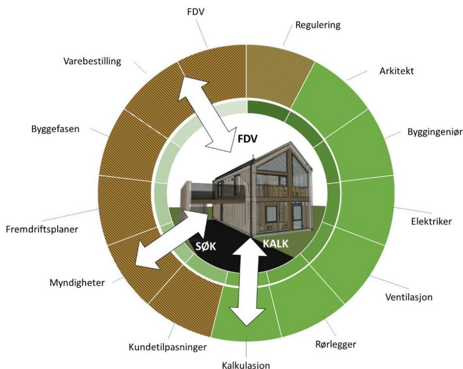
Figur 29: Potensielt bruksområdet for BIM-modeller igjennom hele byggeprosessen for småhus. Grønn farge representerer hvor stor grad Norgeshus har klart å ta i bruk BIM-modellen i 2019 (Norgeshus, 2019).
