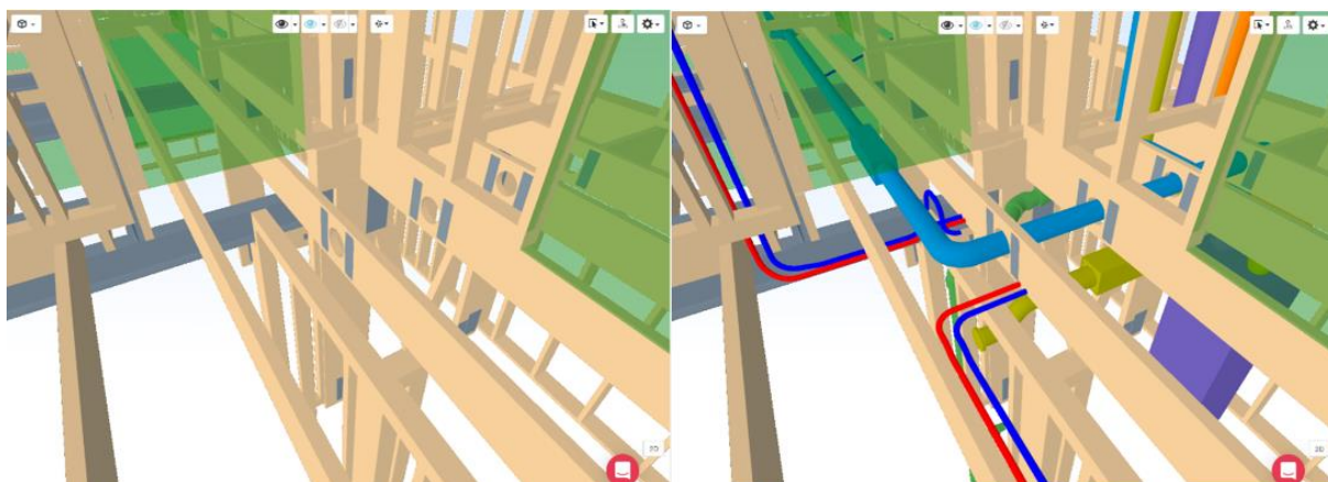
Figur 24: IFC-modell av RIB og IFC-modell sammensatt av RIB og RIV.
