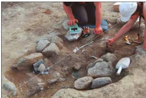
Figur 118. Innmåling av funn med miniprisme. Foto: Ingrid Sommerseth.
