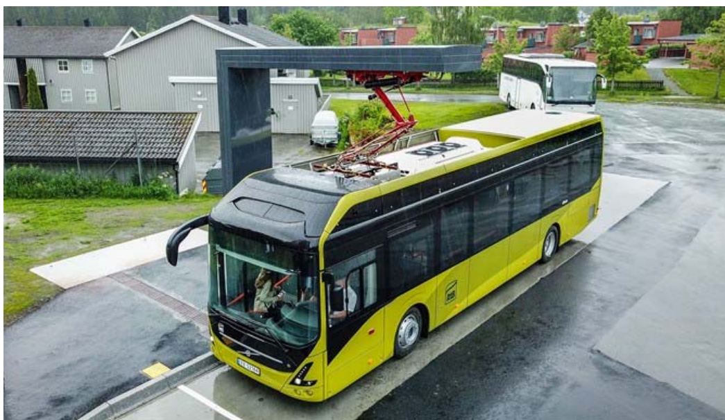
Figur 25: Pantograf-basert lading av elektrisk buss i Trondheim (Bilde: Enova)
