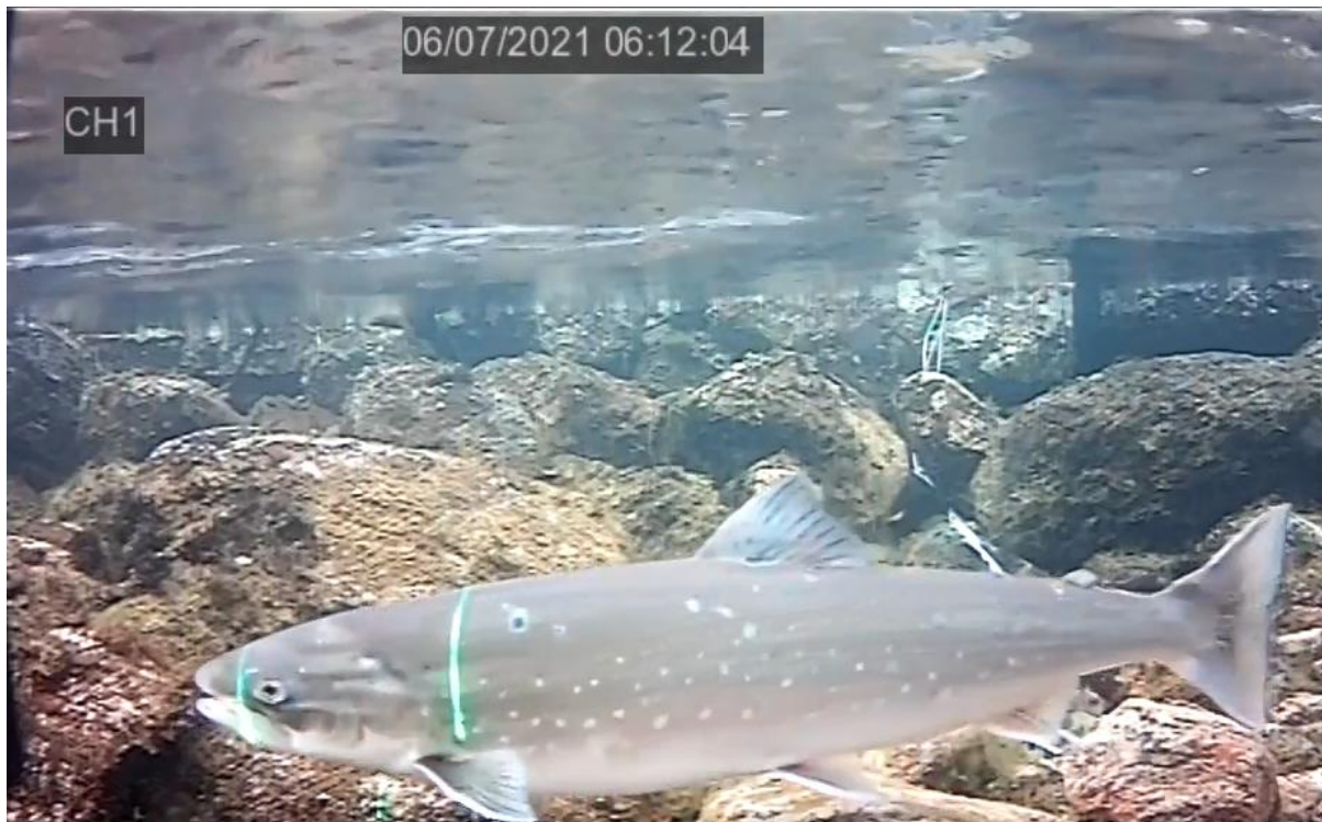
Figur 6. Røye som svømmer oppover i elva forbi videokamera og laserstrekene. Bildet viser hvordan de to parallelle laserstreker treffer fisken, samt dato og klokkeslett for denne fisken med ID A 72.
