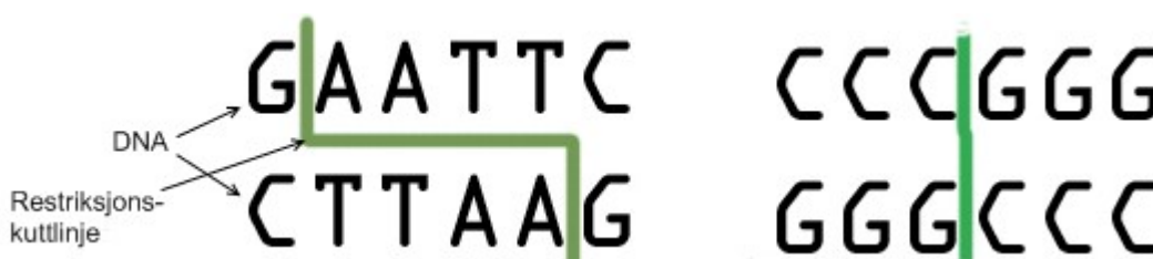
Figur 12. Visualisering av de to typer kutt produsert av restriksjonszymer. Til venstre ser vi et "sticky end" kutt laget av enzymet EcoRI , mens vi på høyre side ser et "blunt end" kutt laget av enzymet SmaI .
