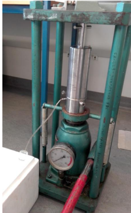
Figur 11: French press system i bruk for lysering av celler. Foto: Unni L. Lande.
