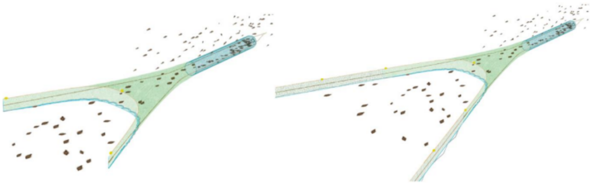
Figur 3: Snurrevaden med korte (venstre) og lange vinger (høyre) (Ingólfsson et al., 2023).
