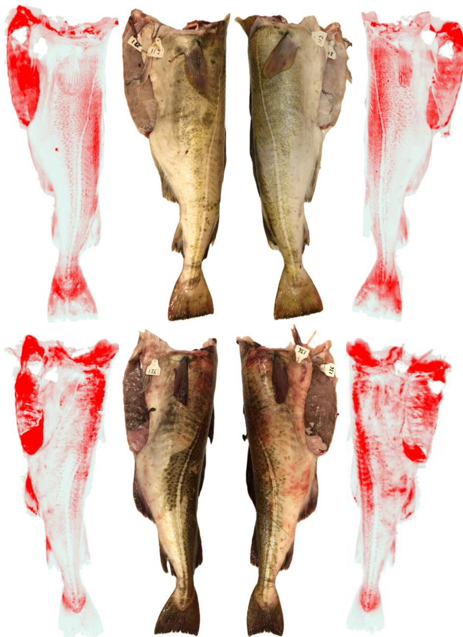
Bilde 2 Øverst: foto og analysebilder fra hyperspektral avbildning av en fisk med totalscore «1» i fangstskadeindeksen. Nederst: foto og analysebilder fra hyperspektral avbildning av en fisk med totalscore «8».
