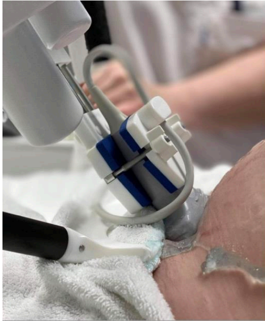
Bilde 2: Ultralydproben er festet til robotarmen slik at den lar seg fjernstyre av gynekologen i Hammerfest.
