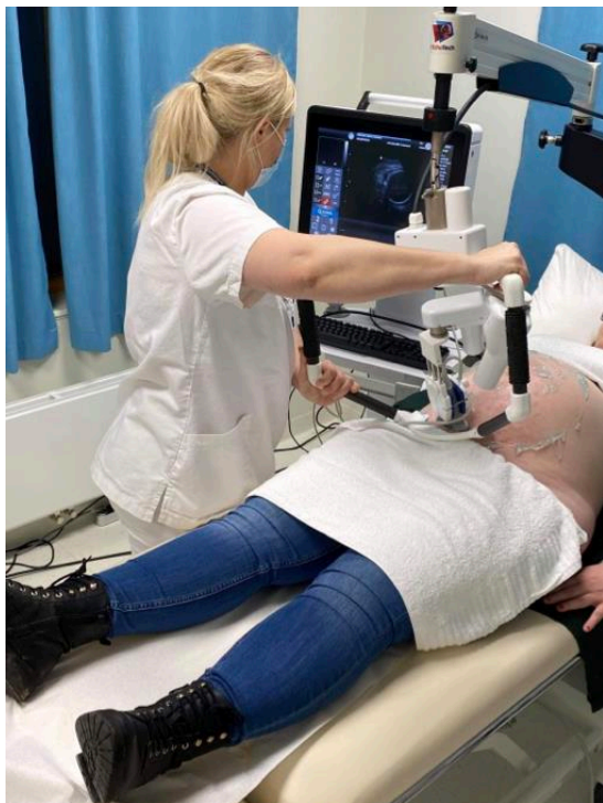
Bilde 1: Jordmor i Alta flytter robotarmen med fastkoblet ultralydprobe på den gravides mage, etter gynekologens anvisninger.
