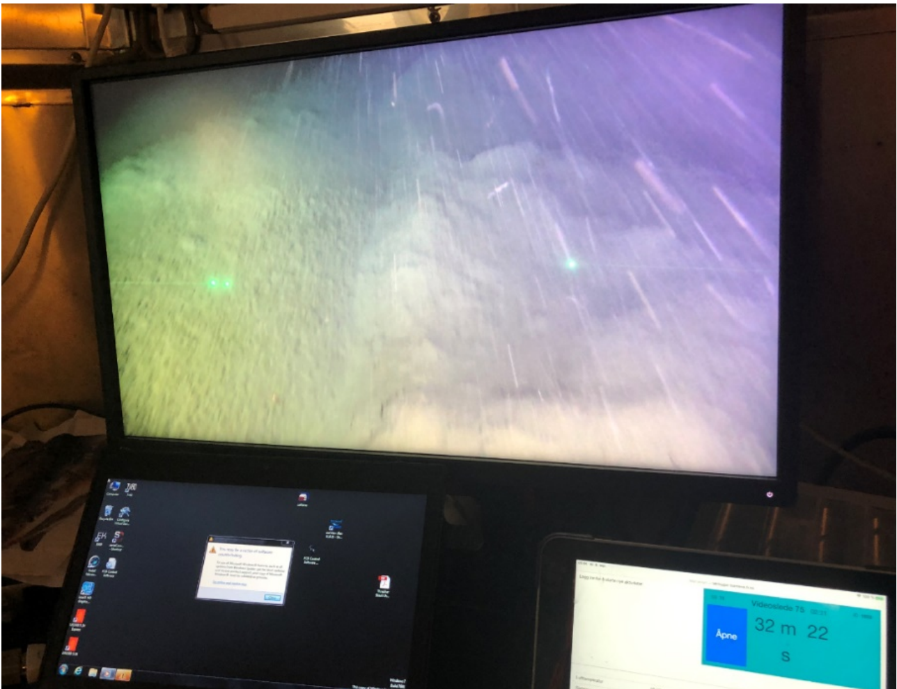
Figur 4. Skjerm som viser høyre kamera med laserpunkter og iPad med toktlogger som viser tiden.
