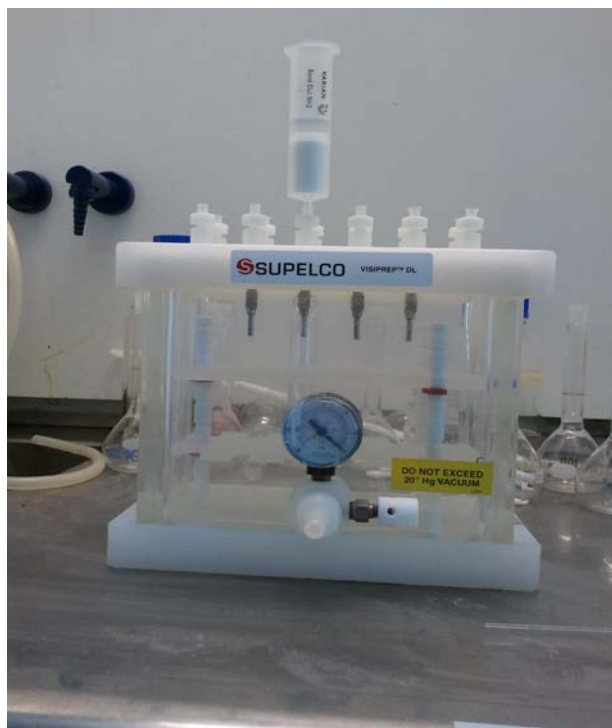
Figur 3-2: Instrumentering for separasjon med SPE.
