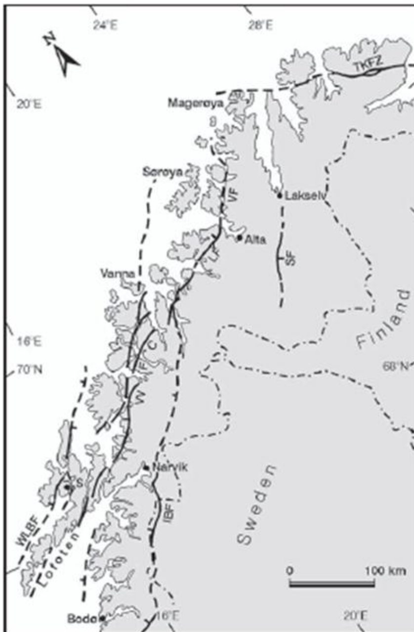
Figur 1.7 Regional kart som viser noen av de mesozoiske hovedforkastningene (kompleksene) på land i kystområdene av Nordland, Troms og Finnmark LF- Langfjorden, VF Vargsund forkastning, TKFZ- Trollfjorden-Komagelv forkastningszone, WFC- Vestfjord-Vanna forkastningskompleks, WLBF-vest-Lofoten grenseforkastning. S- Sortland (Roberts, et al 2005).
