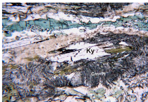
Figur 3.28: Mikroskopbilde av kyanitt som brytes ned til korund, plagioklas og spinell. Lengste bildeakse 1,6 mm
