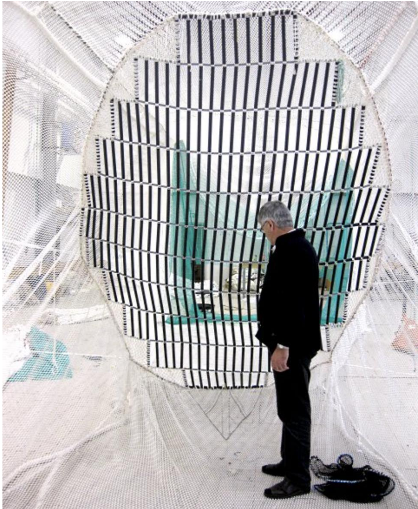
Figur 12: Bilde av shetlandsrist som er sydd inn i en kolmuletrål. Bilde fra: (Ånensen, u.å.).
