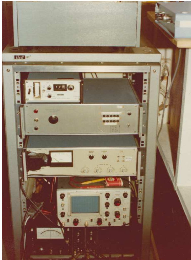
Figur 2.13. Elektronikken fikk plass i et halvt rack. Fra toppen: Papirskriveren, høyspenningskilden til fotomultiplikatorene, lavspenningskilden til forforsterkerne, ratemeteret, oscilloskopet, og den faselåste forsterkeren helt nederst. Den lyseblå boksen til høyre for skriveren er kontrolleren til steppermotoren som roterte chopperbladet. Fra «Brukerbeskrivelse for T-21».
