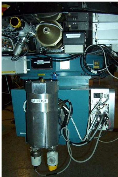
Figur 8.3 ALFOSC – The Alhambra Faint Object Spectrograph and Camera, montert på NOT. (hentet fra the ALFOSC page https://www.not.iac.es/instruments/alfosc/ foto R.Rebola)
