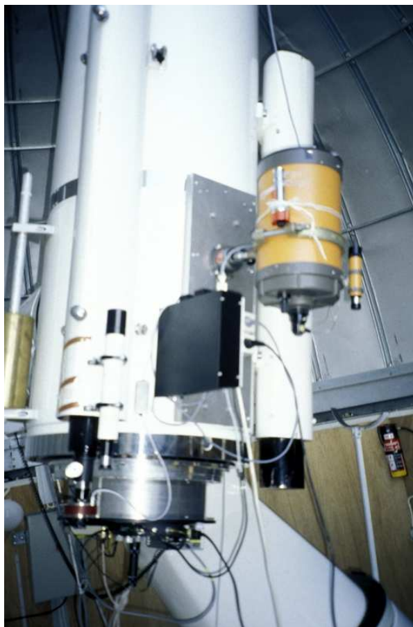
Figur 11.19 Skibotnteleskopet i 1990-årene. Vi ser Celestron 8 på siden som guideteleskop. Pannekakefotometeret er koblet til en fokusforlenger.
