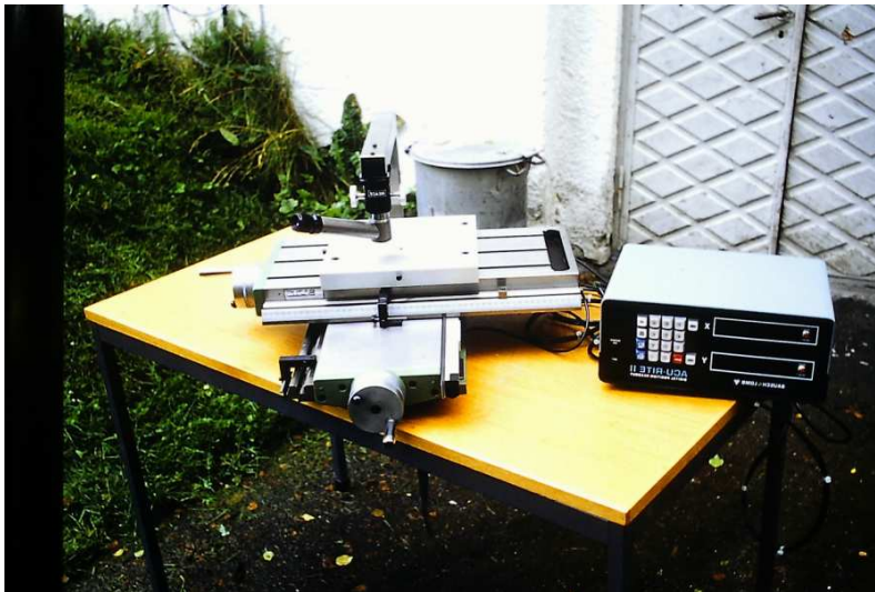
Figur 9.7. Målebord for utmåling av posisjoner på platene. Det hadde en målenøyaktighet på 2\ \mu\text{m} .
