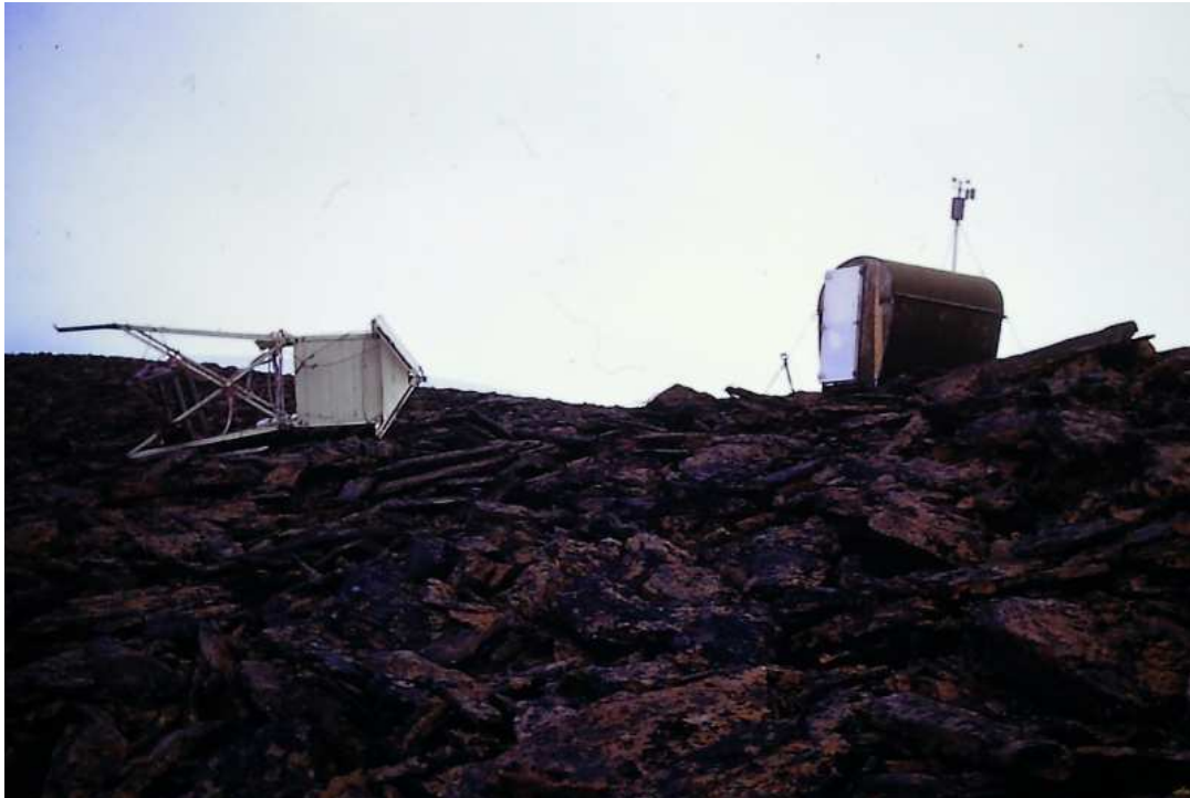
Figur 1.12: Hvilehytte og meteorologisk observasjonsbur fløyet opp på Addjets høyeste topp medhelikopter i oktober 1972, Begge ble festet med stålwire til bakken som bestod av løse steinblokker.
