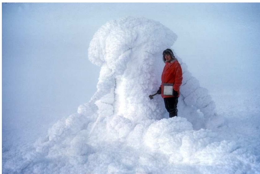
Figur 1.8 Kraftig ising gjorde at vi ikke fikk fornuftige temperaturdata fra Kistefjell – her ser vi Svein Sivertsen hogge ut temperaturskriveren fra meteorologiburet. Foto: Odd Fjordheim
