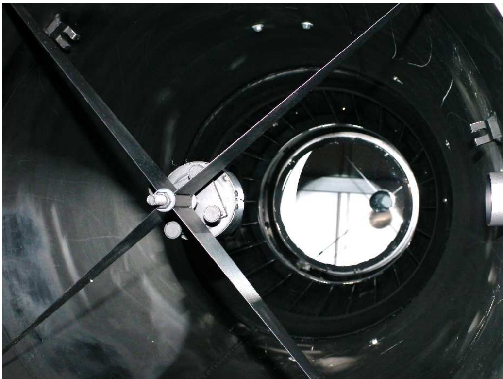
Figur 12.2. Nytt 50 cm hovedspeil og sekundærspeil i teleskopets Newton system. Foto Pål Tengesdal.
