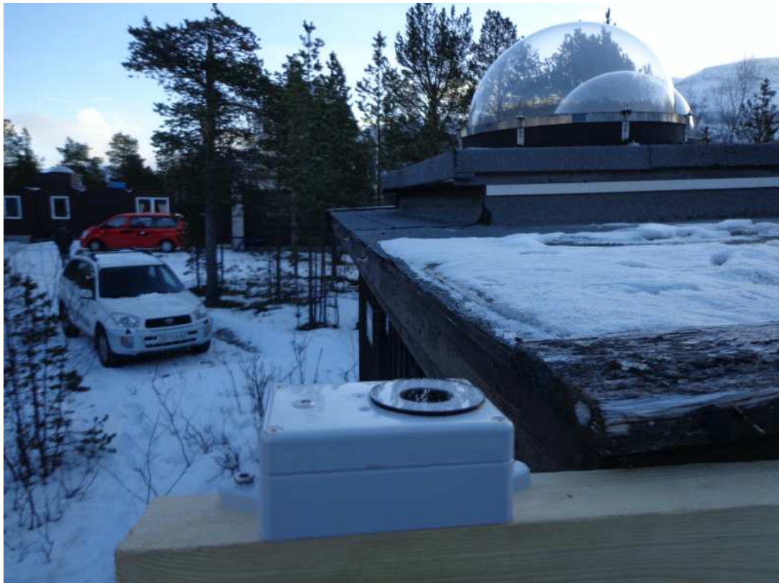
Figur 13.5. Bildet viser TESS-fotometeret i Skibotn med de optiske nordlyskuplene og teleskopbygget i bakgrunnen bak trærne. Foto: Magnar G. Johnsen
