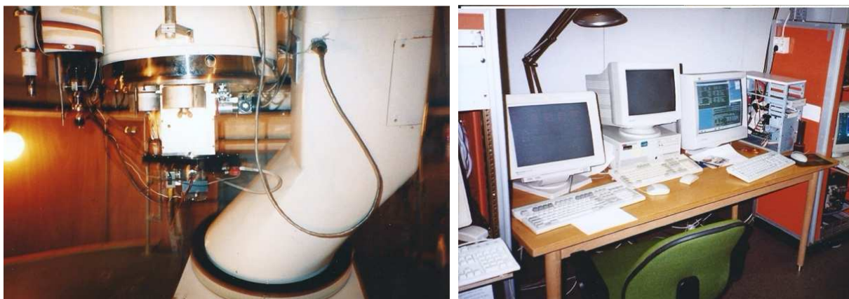
Figur 11.2. TCP montert på teleskopet i Skibotn (til venstre). Vi ser også det nye autoguidesystemet beskrevet i avsnitt 8.3. Til høyre ser vi kontrollpulten med skjermer for bilde, dataanalyse og kontroll av FASU og guideteleskopet.
