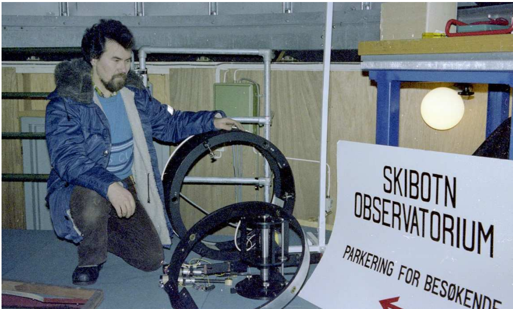
Figur 8.4 Reidar Persen med den opprinnelige fokuseringsringen med tre-motors fokusering og deler til et en-motors design foran. (foto: Lennart Berger).
