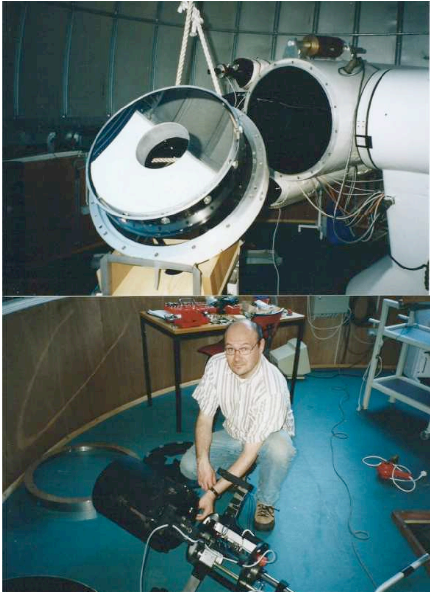
Figur 11.20 Frank Johannessen utfører service på teleskopet. Øverst tas hovedspeilet ut for vask. Nederst inspiserer Frank sekundær-speilholderen med sin fokuseringsmekanisme som består av en styringsleide. Da teleskopet ble levert, hadde den 3 stag for kollimering og fokusering. Siden disse hadde hver sin motor var det vanskelig å holde sekundærspeilet kollimert, og fokuseringen ble derfor bygget om til en tannstangsleide (se figur 8.6).
