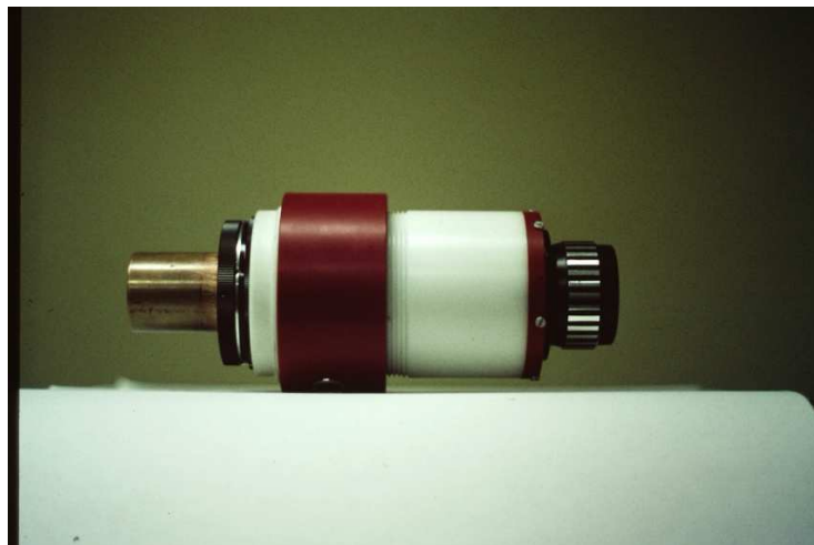
Figur 8.2. Billedforsterker modifisert for bruk på teleskop (foto R. Kalleberg)
