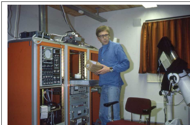
Figur 3.17. Ove Harang med instrumentrack for nordlysobservasjoner. Det er trolig en spektrograf som står til høyre i bildet. På toppen av det nærmeste racket ligger vår første OLT mobiltelefon, VLF med manuelt oppkall til sentral. Den ble brukt under flere av turene til fjells.
