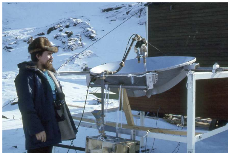
Figur 7.6. Reidar Persen ved Instrumentet for måling av 3 cm bakgrunnsstråling på fjellet ved Lavka. I fokus på parabolspeilet sitter to feed-horn med mekanisk switch, og på kassen i forgrunnen er det en hornantenne for bakrunnsreferanse. Foto Lennart Berger.
