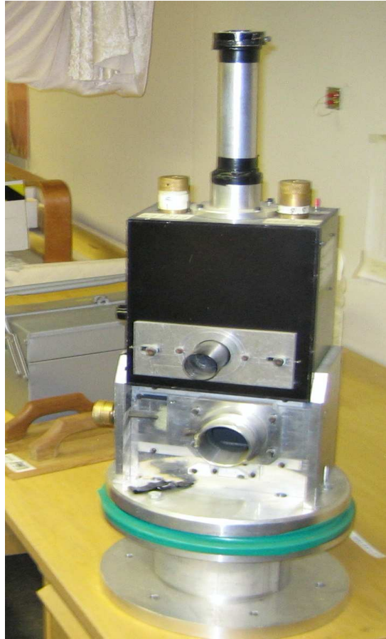
Figur 4.8. Chopperfotometeret i januar 2019. De to okularene er fjernet, ellers ser det greit ut. Forlengeren i forkant av fotometeret (nederst på bildet, under den grønne tapen) ble laget for å plassere Chopperfotometerets fokus like langt bak teleskopet som Tokanalsfotometerets fokus, for å slippe å fokusere så mye ved instrumentbytte. Foto: J.-E. Solheim
