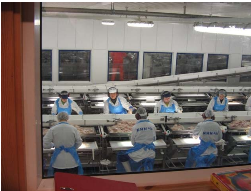
Bilde 9 Trimmelinja ved NHN sett fra filetkontoret, nakkekutting, filetering og skinning foregår i avdelingen på andre siden av veggen.
