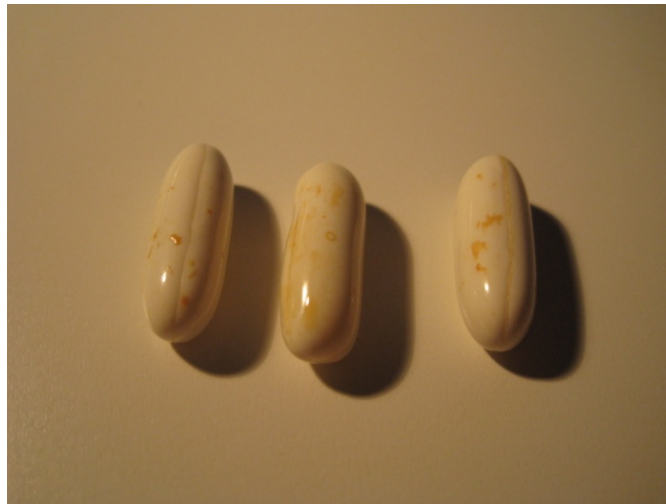
Figur 4.1: Kapsler med brune flekker (Batch D, med glycerol og sorbitol som mykgjørere).
