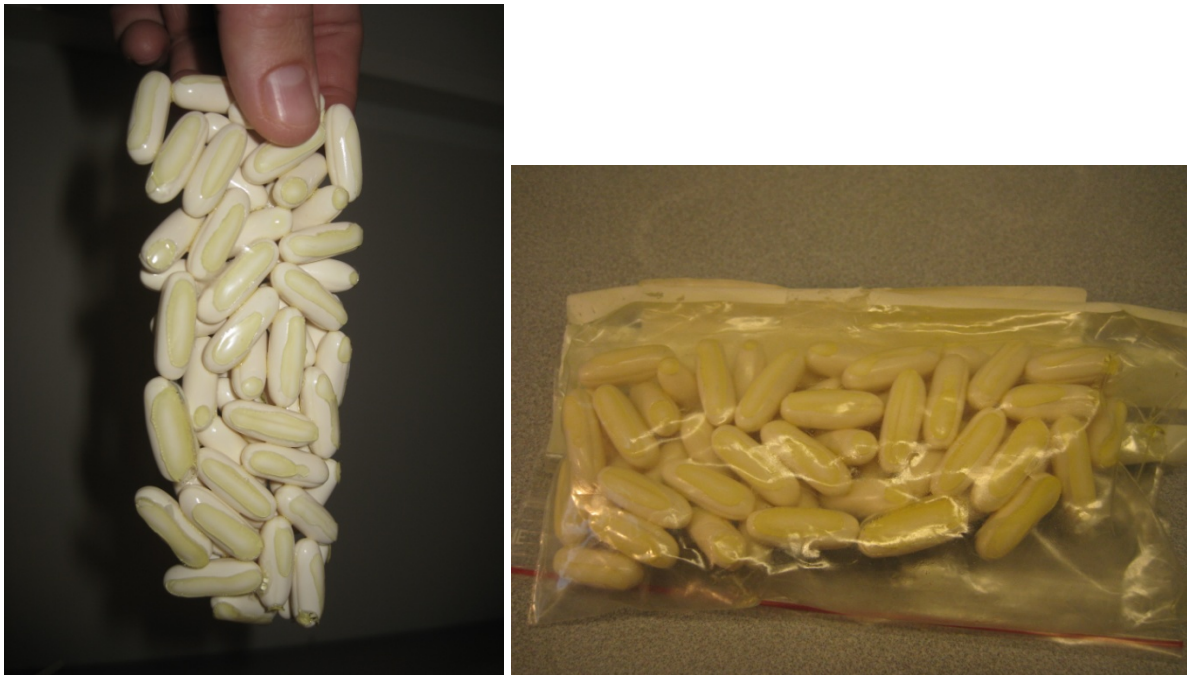
Figur 4.8: ”Blooming” og sammenklebing av kapsler med sorbitol observert under lagring.
