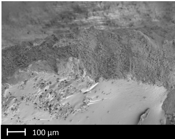
Figur 4.6: SEM: Innsida til kapselskall med hvitt pulver. Bildet til høyre, B (x550), er mer forstørret i området med pulver enn A (x120).
