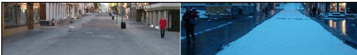
Figur 23. Storgata om sommer og vinter; kjøresonen i midten er ikke oppvarmet. Eget fotografi, 2006.
