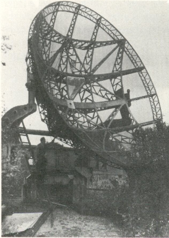
Radaranenne - opprinnelig krigsbytte fra Vigra festning i 1945. Denne ble brukt til å studere signaler fra nordlysutbrudd før antenneanleggene i Lavangsdalen og på Ramfjordmoen ble bygget.
