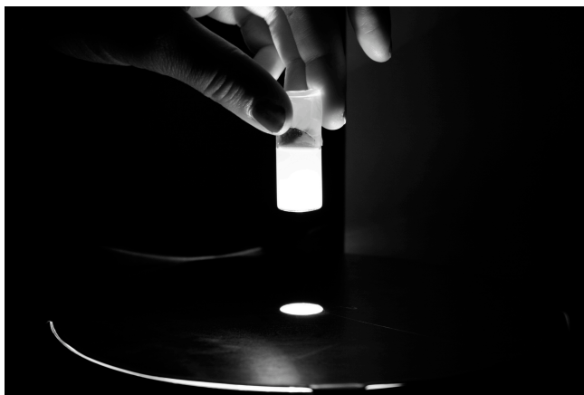
Figur 7: Tyndallopsettet: gjennomlysning av vannfasen
