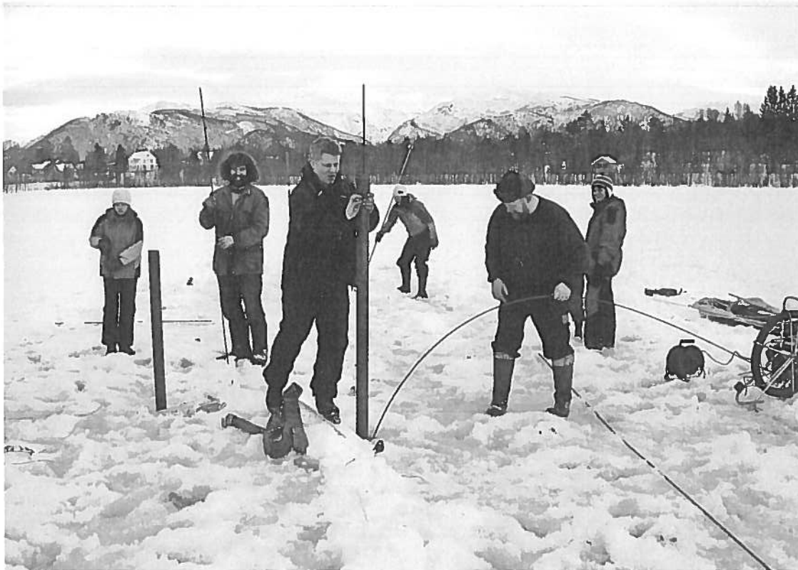
Figur 5. Bruk av rørinspeksjonskamera under staking gjennom isen på Fiskvågvatnet.
