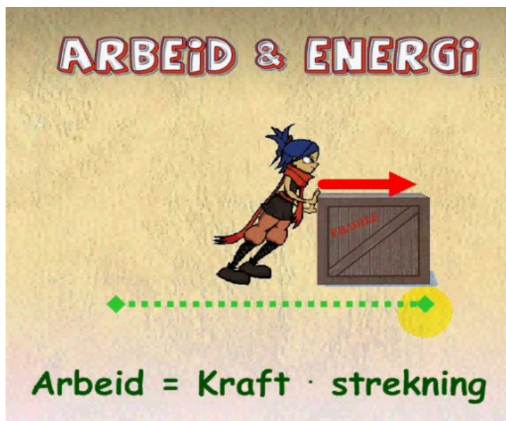
Figur 14: Eksempel på arbeid som brukes på å overvinne friksjon
