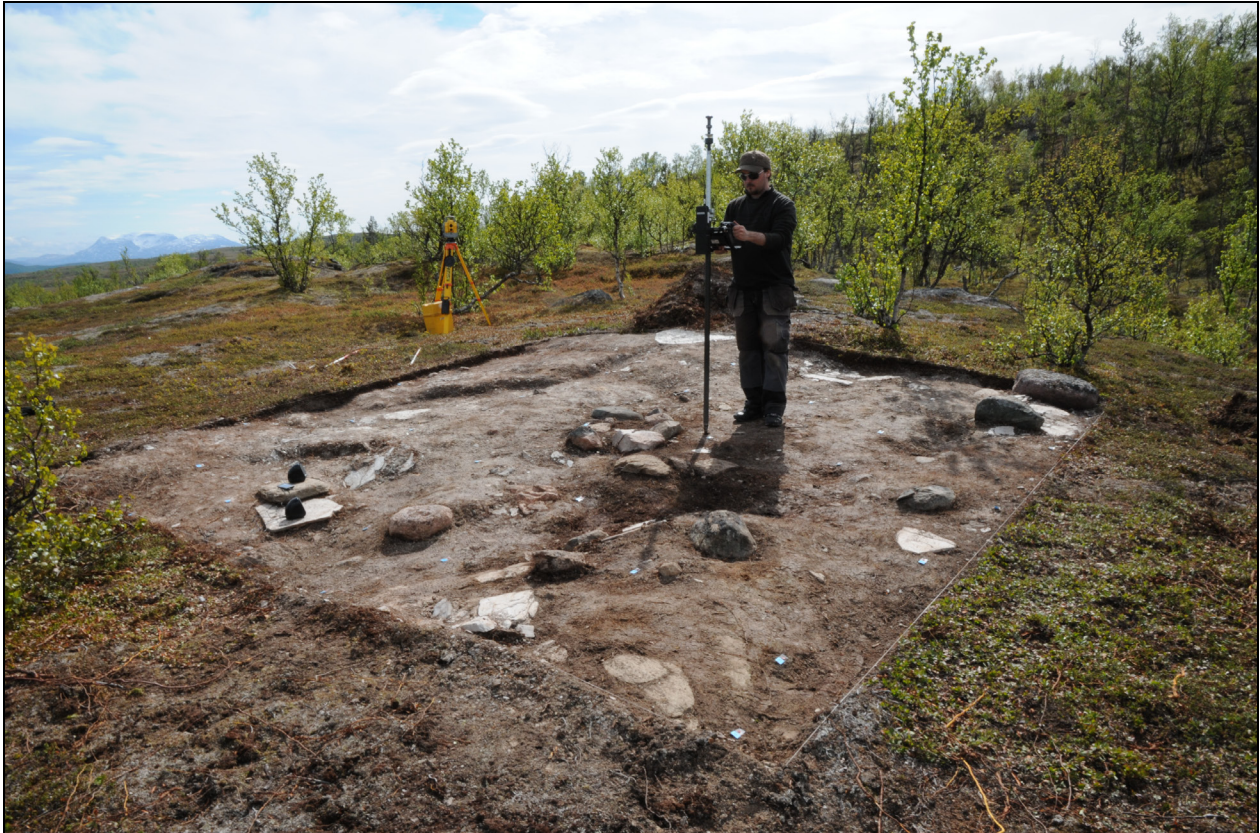
Figur 7. Stefan Bakke benytter totalstasjon og Intrasis til å måle inn strukturer, prøver og topografi ved lokalitet 122714.
