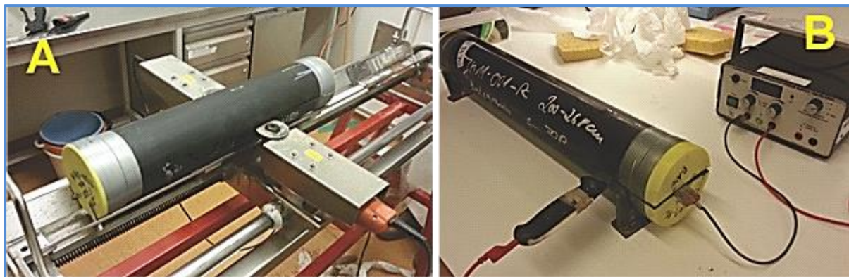
Figur 3. 3. Åpning av kjerne med bruk av vibrasjonskutteren (A) og osmotiske kniven (B)
