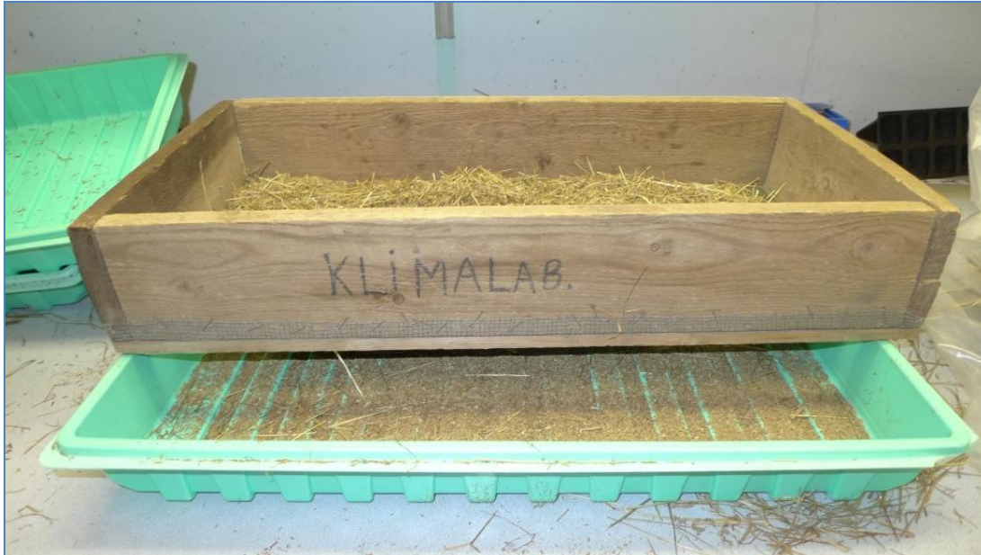
Figur 2. Plantemateriale blir sortert gjennom ramme med rist. Frø faller igjennom og annet plante materiale blir liggende oppå risten. (Klimalaboratoriet på Holt, Tromsø)
