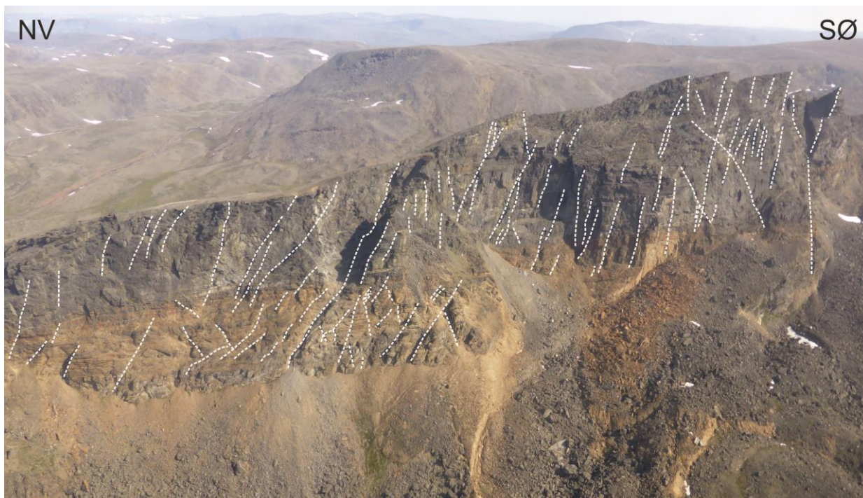
Figur 4.14 Identifiserte post-kaledonske sprekker i bakveggen langs den nordvestlige delen av fjellryggen. Merk sprekkenes vedvarende natur.
