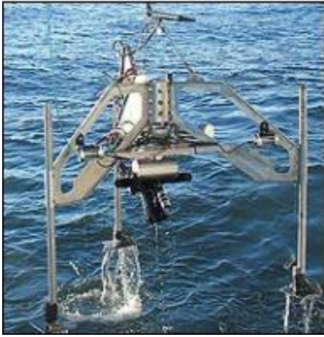
Fig. 3.3: Videoriggen Campod, som brukes til å filme havbunnen (Mareano, 2014c)
