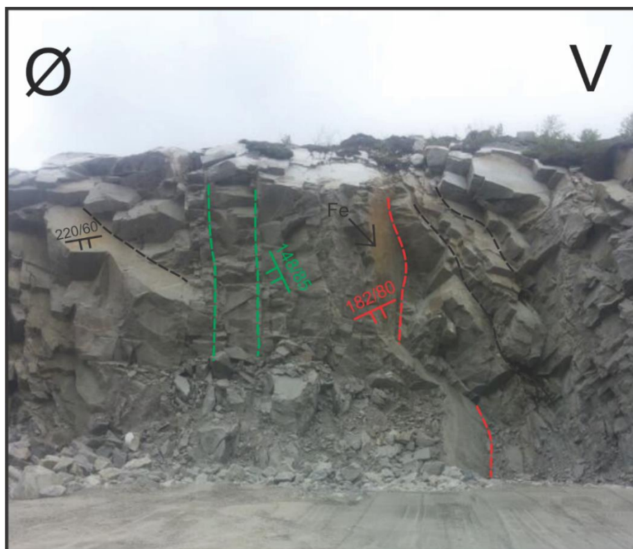
Figur 16 illustrer den krysskuttende relasjonen mellom de ulike populasjonene og bruddflater fra populasjon 1 (rød) og 2 (svart) som er dekket med oksidert jern.
